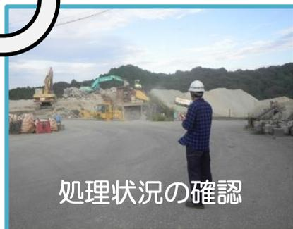
工事で発生した産業廃棄物は、工事に産廃処理契約をした処理業者へ運搬し処理しています。コンクリート殻は再生クワッパという再生資材にリサイクルし、工事現場の路盤材や構造物の基礎材・裏込め材として利用しました。
