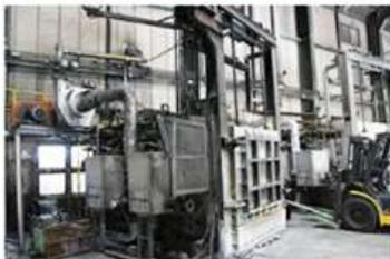
ガス鍛造加熱炉 (横面)
