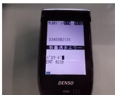
エラー発生時の解除に制限を設
