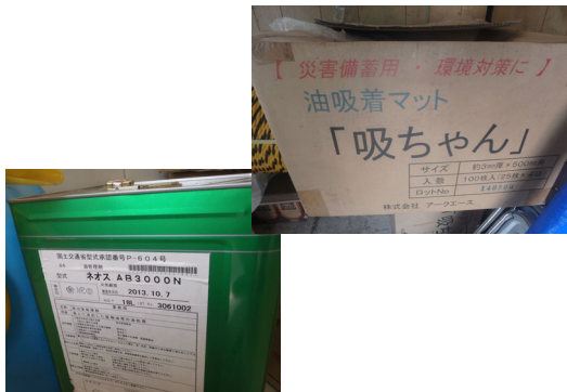
緊急時対応:油流出事故対策 (油処理剤・油吸着マット 配備)
