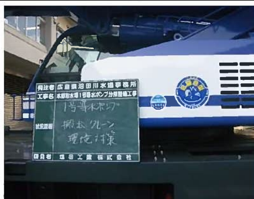
排ガス規制適合ラフタークレーン使用
