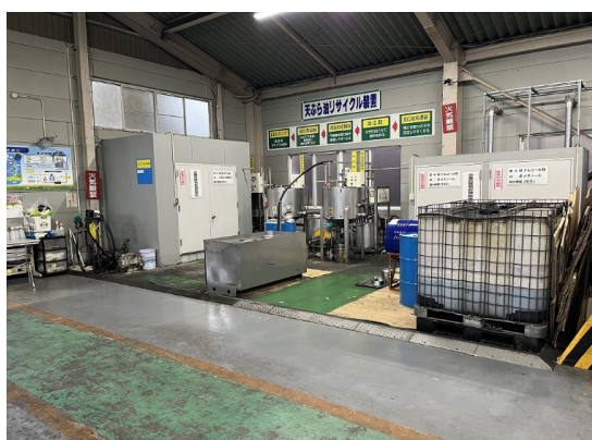
天ぷら油リサイクル装置 (BDF 反応機)
