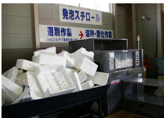
発泡スチロールリサイクル装置(選別⇒溶融・固化)
