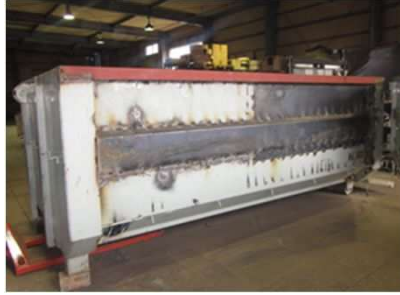
塗装・錆落とし作業
