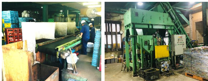
左:ベルトコンベア 右:缶プレス機
