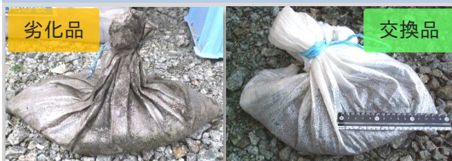
劣化した砂袋の更新
