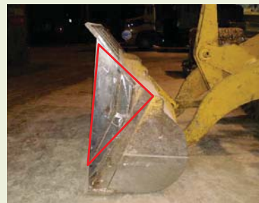
小型重機のバケットの高上げ
