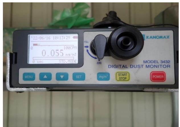
粉塵計測器での常時粉塵発性状況の監視実施状況
