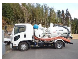
はつりに使用した濁水やはつり殻を回収する強力吸引車
