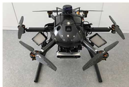
高所点検ドローン
