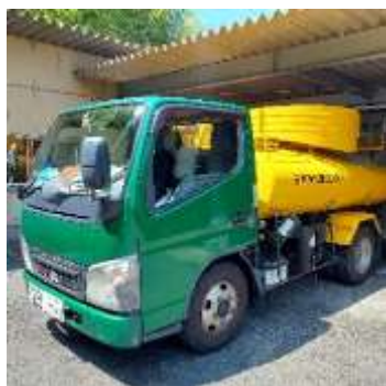
バキューム車(浄化槽清掃)
