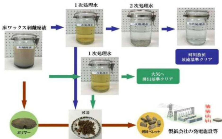
※処理システムの特徴は、CO<sub>2</sub>の排出量を抑え（焼却と比較した場合60%削減）、ポリマーと残渣をリサイクルし、捨てるものが何もないシステムとなっています。
