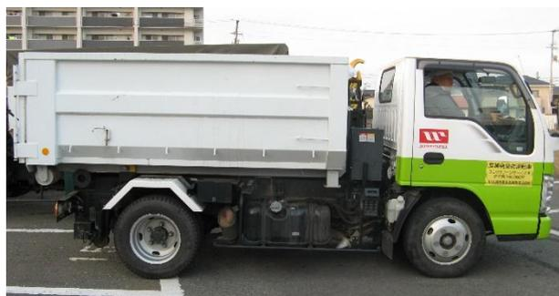
脱着式コンテナ車（4t2台、2t1台）
