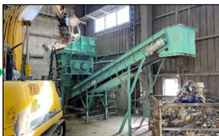
二軸破碎機による一次破碎（粗破碎）
