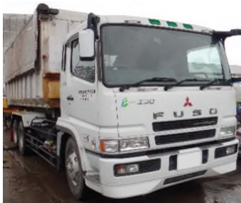
【 脱着装置付きコンテナ専用車 】 コンテナを脱着できるので現場にコンテナだけを設置する事が出来ます。
