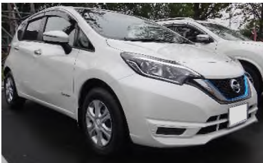
【 ハイブリッド車 】 ガソリンエンジンで発電し、電気モーターで走る為、低燃費です。営業車で使っています。
