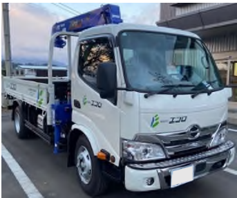
【 クレーン付きトラック 】 車両のクレーンで荷台に重量物を載せる事が出来ます。
