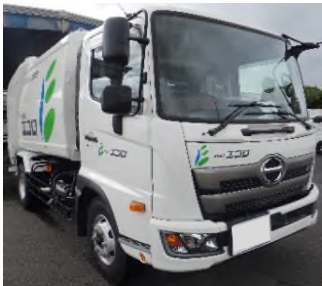
【 パッカー車 】 圧縮式のゴミ収集車です。圧縮しながらゴミを多く積み重ねることが出来ます。
