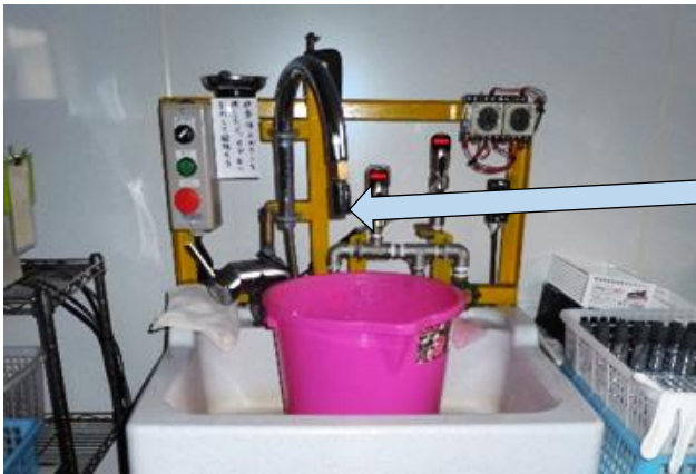
※通水・耐圧検査装置（右の写真の浄水器の蛇口を取付け通水等の検査を行う）
