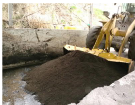
水分調整(堆肥混合)
