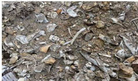
燃え殻を細かく粒度毎に選別し、更に金属くずを回収します。
