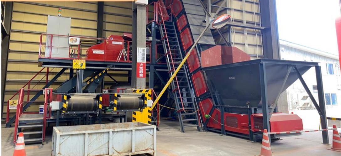
高森RCSでは、赤外線高度金属選別機で選別した非鉄を、以前はそのまま非鉄としてリサイクルを行っていましたが、その非鉄を更に選別し、種類別にリサイクルが行える様に令和5年3月に蛍光型X線高度金属選別機『XRFライン』を導入致しました。
