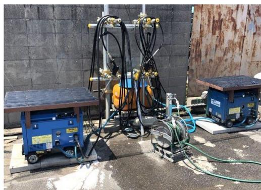
高圧洗浄機の追加導入、給水タンクへの止水フロートの取り付けを行いました。
