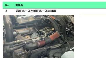
手順 高圧ホースと低圧ホースの損傷・濡れが無いか目視で確認する
