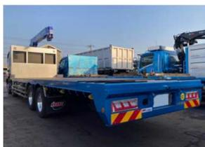
大型低床クレーン付重機運搬ボデー
