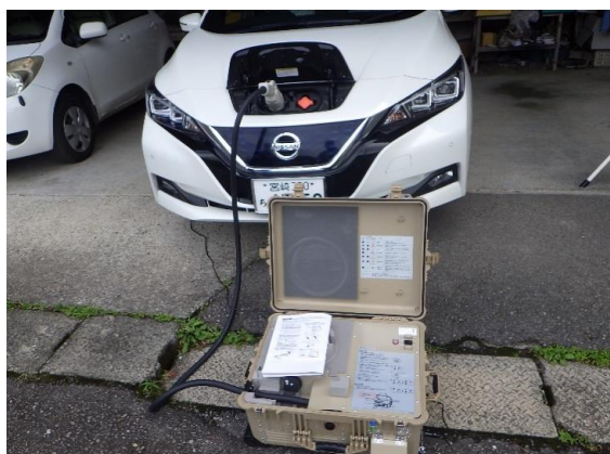
パワームーバーを電気自動車と接続したところ
