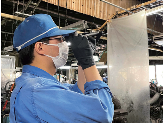
濃度計を用いて適切な濃度になっている確認。また、カビや異臭のチェックも。
