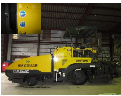
工事設計書では規定されていない排出ガス対策型の車両(アスファルト・フィニッシャ)の使用しています。
