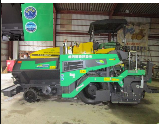
工事設計書では規定されていない排出ガス対策型の車両(アスファルト・ミニフィニッシャ)の使用しています。
