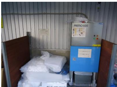
ごみ圧縮機で体積換算で65%削減目標
