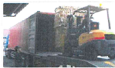
投入口にダンボールなど古紙を投入 コンベアーで運ばれて圧縮される(1個/1t) 生成物は国内製紙メーカーに送られる
