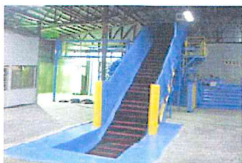
投入口にダンボールなど古紙を投入 コンベアーで運ばれて圧縮される(1個/1t) 生成物は国内製紙メーカーに送られる
