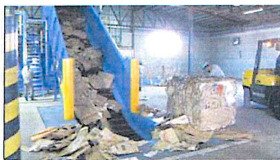
投入口にダンボールなど古紙を投入 コンベアーで運ばれて圧縮される(1個/1t) 生成物は国内製紙メーカーに送られる
