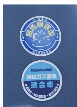
道路改良工事での使用機械 バックホウ0.5m 3 1997年基準値超低騒音型 2014年基準排出ガス対策型 (オフロード法)
