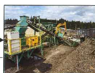
③RC-13オーバー破碎状 況
