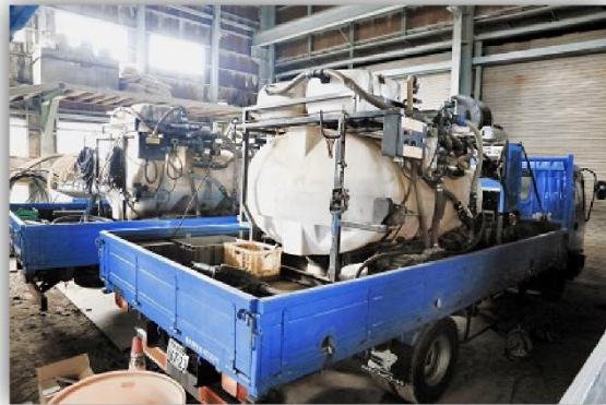
当社のグリンドリル搭載車 (油圧ユニット、ベントナイトミキシング装置)
