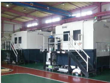
マキノライ工業 MAG1 (5軸制御) 50 ~ 33,000 回転 ストローク: 1,520 × 1,100 × 1,350
