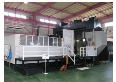
ヤマザキマザック V140N 門形マシニング 10 ~ 10,000 回転 ストローク: 7,000 × 4,600 × 1960
