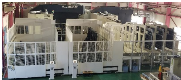
マキノライ工業 MAG3 (5軸制御) 50 ~ 33,000 回転 ストローク: 4,000 × 1,800 × 1,000 (6パレットシステム導入)
