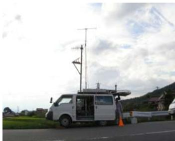
無線通信回線を机上設計し、机上検討による回線を実際に現地で調査します。他に河川の放流警報(サイレン)の音達調査等も行います。
