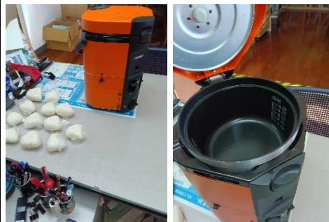
ガスボンベ焚き炊飯器
