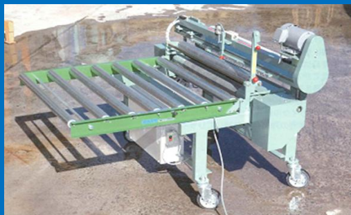
廃畳切断施設全体図 切断処理能力・12 t / 日
