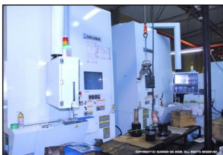
縦型NC旋盤(オークマ)
