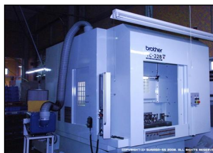
縦型タッピングセンター(ブラザー工業)
