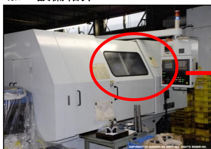
横型・外径研削盤(太陽工機製)
