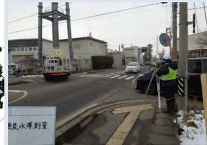
通常2人で行う測量が1人で完了する測量器
