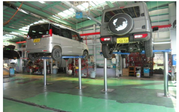
リフト2基の新設で作業の安全性と効率の向上を図りました
