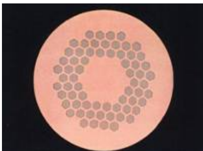
NbTi 超電導線の断面
