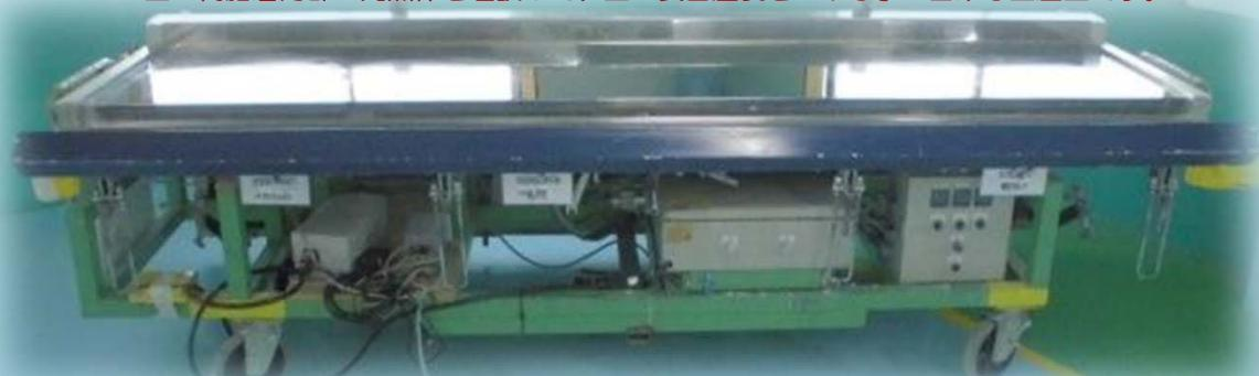
※型内部にセンサーが埋め込まれているので、専用の制御盤にて簡単に温度設定・温度管理が可能です。
