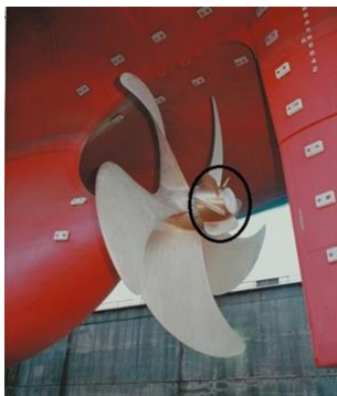
PBCF (Propeller Boss Cap Fins) プロペラ効率改善装置
