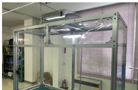
自社で設計製作したクリーンベンチです
