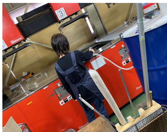
洗浄液の注入
